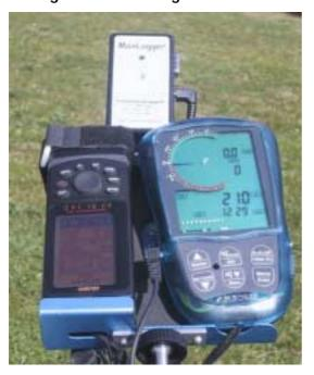
Der MaxLogger erfordert keinerlei Bedienung während des Flugs. Man kann ihn deshalb problemlos in eine Tasche stecken, nur über das Kabel mit dem GPS verbunden. Da es jedoch etwas beruhigt, an der LED zu sehen, dass der MaxLogger arbeitet, ist es vorteilhaft, einen kleinen Platz auf dem Instrumententräger vorzusehen.
