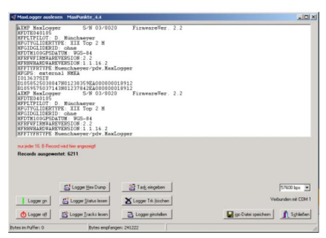
MaxPunkte speichert die Baudrate und den verwendeten ComPort für spätere Programmaufrufe. Diese Werte müssen nicht jedes Mal neu eingegeben werden. Bei Erstaufruf wird außerdem der Name eines Log-Files abgefragt, das immer wieder verwendet wird. Hierin wird die Datenübertragung vollständig protokolliert.
