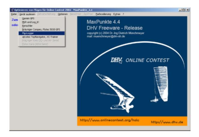
Dort startet man das Menü "Gerät auslesen" => "MaxLogger". Zunächst. In dem jetzt geöffneten Fenster wählt man zunächst den angeschlossenen COM-Port. Wird das Programm wieder gestartet, so wird wieder der bereits früher gewählte COM-Port gesetzt. MaxPunkte prüft, ob der gewählte Port frei ist; wenn dieser bereits durch ein anderes Programm belegt ist, lässt MaxPunkte die Einstellung nicht zu. Mit dem Button "Logger On" wird der MaxLogger eingeschaltet, was an der LED kontrolliert werden kann.
